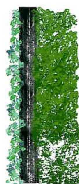
absorberend scherm op keerwand ingepast met gemengde haag (snelwegzijde) en klimmende beplanting (bewonerszijde)
