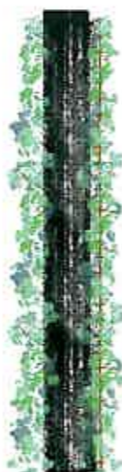
klimhulp tegen scherm; begroeiingsgaas (bijv. pantanet) om de beplanting te begeleiden die dat nodig heeft
