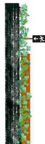
vluchtroute; warm donkerbruine deur (*Brun 650 Sable SW308F (Akzo Nobel)) met brede naar voren komende neggen van cortenstaal
