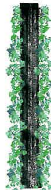
absorberend scherm op keerwand begroeid met klimmende beplanting aan weerszijden
